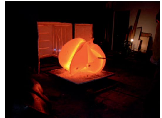
Die glühende Form kühlt nach dem Aufblasen ab.
